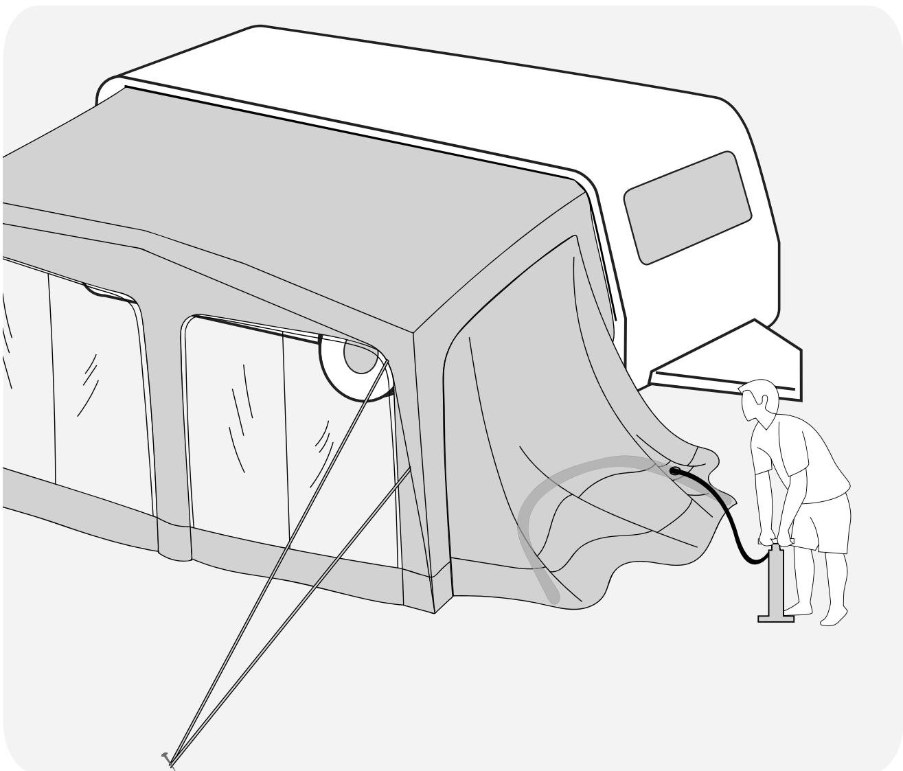
Pumpen Sie nun den Luft Tube auf. Den erforderlichen Druck haben Sie bei 7 PSI erreicht unsere Pumpen werden mit einem Überdruckventil geliefert, welches sich öffnet, wenn sie den gewünschten Druck erreicht haben. Achten Sie darauf die Ventilkappe nach dem Pumpen wieder auf das Ventil zu drehen.
